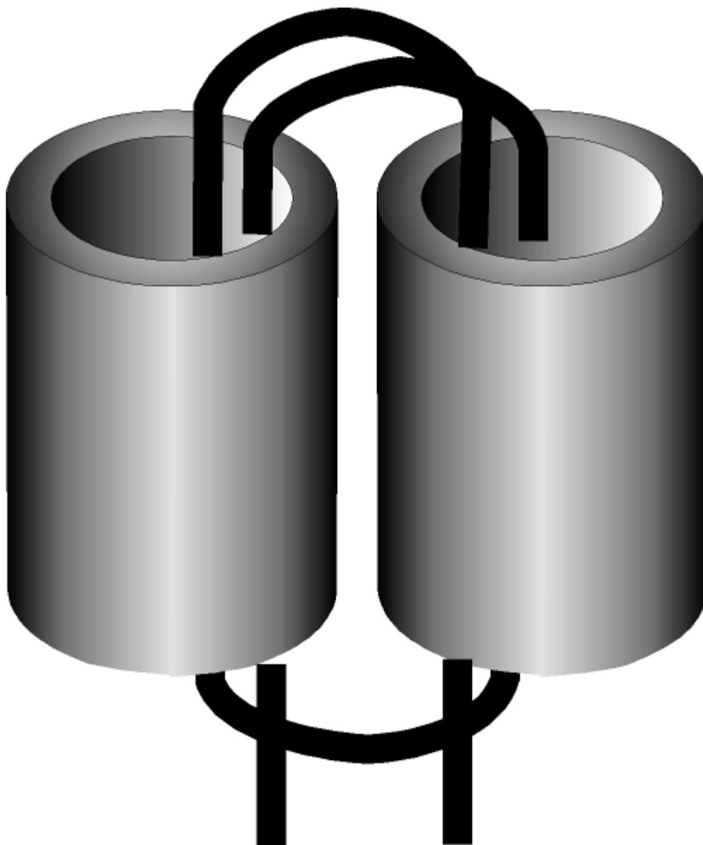
**Vue sur un enroulement avec deux tubes ferrite justaposés**
