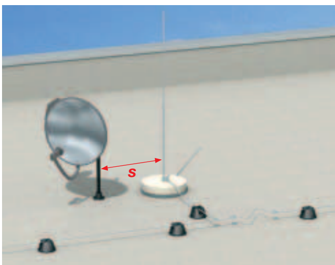
Prawidłowo zachowany odstęp izolacyjny s między urządzeniem odgromowym a instalacją satelitarną
