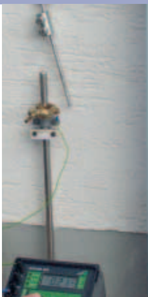
Pomiar rezystancji uziemienia
